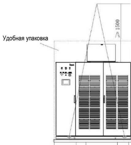
При извлечении системы из деревянных ящиков, ее также можно транспортировать двумя способами: краном или подъемным цепным блоком (или катком для перемещения тяжелых).
